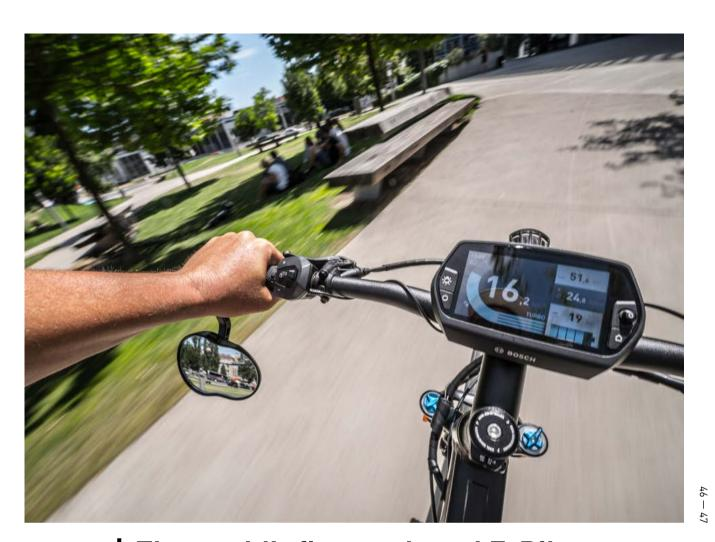
The world's first on-board E-Bike computer, combines all functionality in one unit. Whether it's current speed, cadence, range, navigating via GPS or analysis of personal fitness, this unit does it all. • Der weltweit erste Bordcomputer für das E-Bike, der alle Funktionen in einem Gerät vereint.
